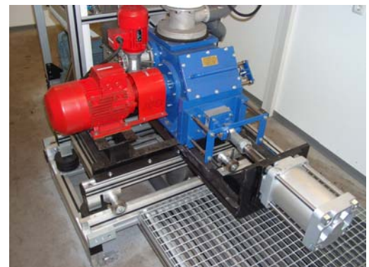
Hammermühle zur Aufbereitung
